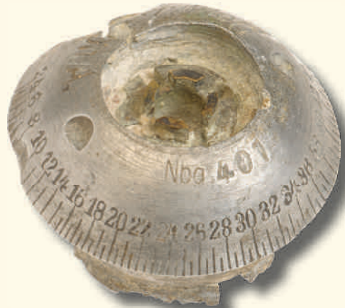
Fusée d'obus allemand de 77 avec graduation destinée à régler l'éclatement du projectile.
