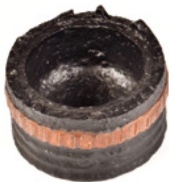
Culot resté entier, après éclatement de l'obus. La cassure s'est faite naturellement au niveau de la diminution d'épaisseur de la paroi de l'ogive. La ceinture aux rayures profondes est restée intacte.
