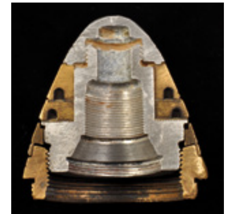
Fusée allemande en coupe. Le canal de mise à feu, en aluminium, est à peu près du diamètre du doigt et par simple sciage on obtenait trois ou quatre rondelles, ébauches de bagues. L'aluminium pouvait aussi être fondu et coulé.
