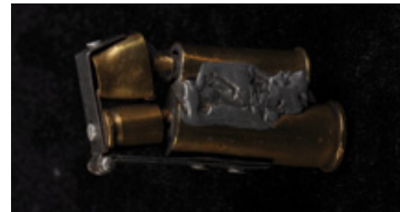
Soudure à l'étain sur un briquet de Poilu. Longueur: 65 mm
